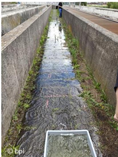
Durch die Aufnahme der voranschreitenden Welle und das Ausbreitungsverhalten (Aufnahme von Wasserständen über die Zeit und die Propagation der Nässungsfront) stehen nun detaillierte Daten zur Verfügung mit denen die Modellanpassung erfolgen kann. In den folgenden Monaten sind weitere Messungen mit unterschiedlichen Oberflächenstrukturen geplant. [► mehr erfahren](#)
