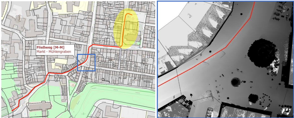
Bild 3-7: Links: Fließweg [M-M] mit Erweiterung des Fließweges zum Neustädter Markt (gelb markiert); rechts: Detail des Fließweges in Karte Laserscandaten
