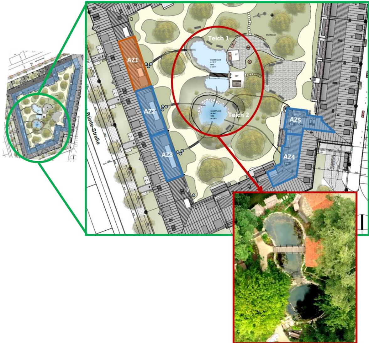
Abbildung 10: An die Teiche im Innenhof (Südstadt) angeschlossene Dachflächen. Bildquellen: Gartenheim, Architekturbüro Kozjak
